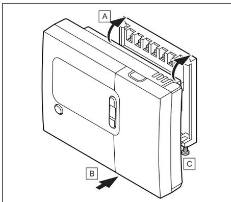
1. Разместите комнатный термостат на монтажной пластине.
