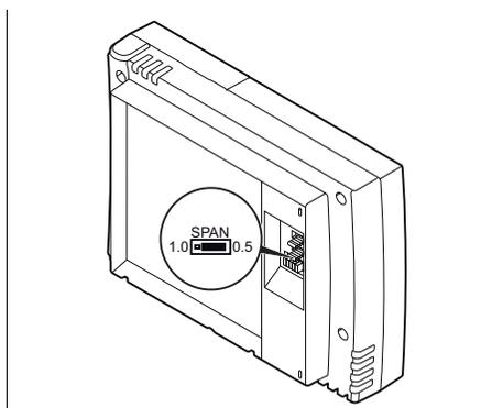
1. Выполните настройку, установив съемную перемычку на обратной стороне комнатного термостата в нужное положение.
