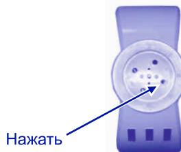
Рис.3. Расположение штока на термовыключателе терmostата
