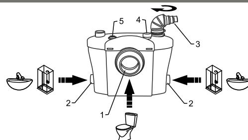
Бытовая канализационная насосная станция SANIVORT 600 предназначена для отвода сточных вод от унитазов, биде, раковин, душевых кабин, находящихся ниже уровня коллектора канализационной системы, а также в удаленных местах, где невозможно или нецелесообразно организовать канализацию самотеком.
