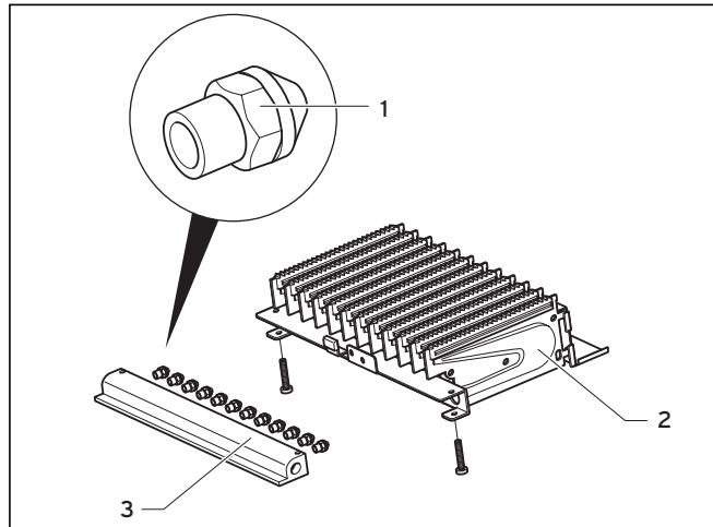
Рис. 6.6 Маркировка сопла
