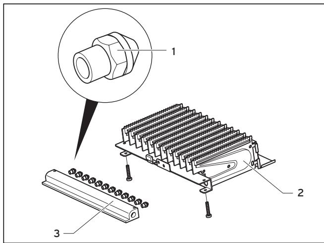
Рис. 6.3 Маркировка сопла
