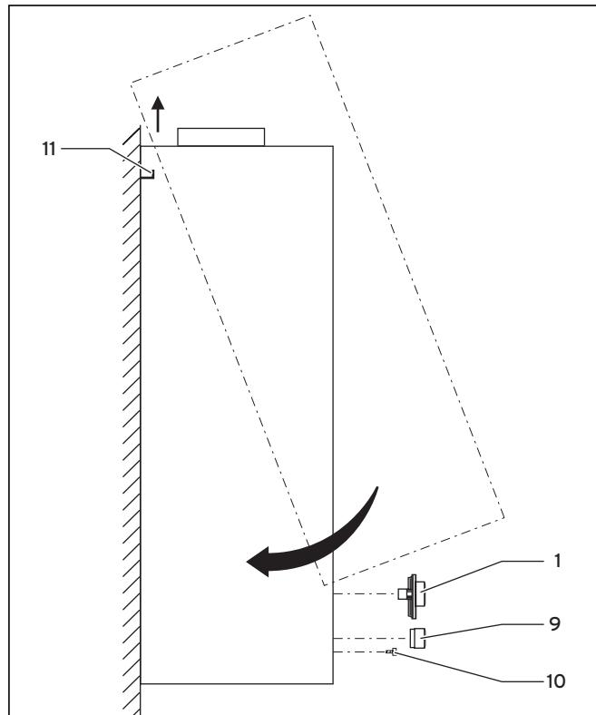
Рис. 4.3 Установка кожуха
