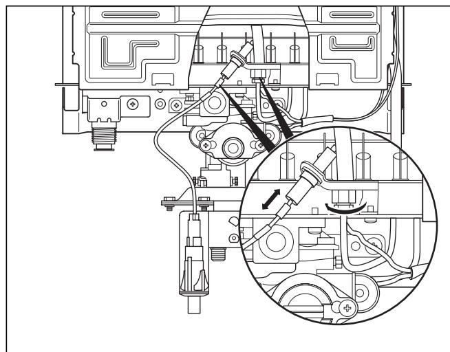
Рис. 7.1 Демонтаж запальной горелки и электрода розжига
