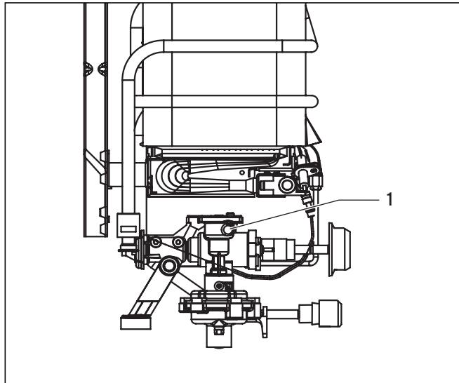
Рис. 6.4 Штуцер для измерения давления на соплах
