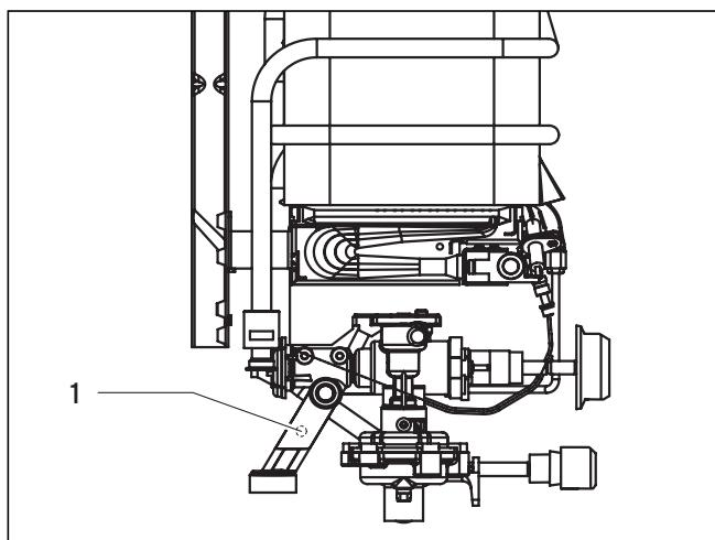
Рис. 6.1 Ниппель для измерения давления газа на входе
