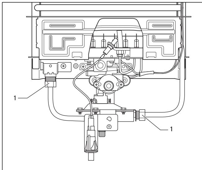
Рис. 7.4 Патрубки подачи и отвода воды на теплообменнике
