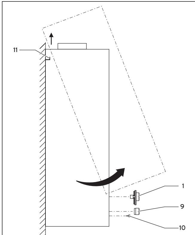
Рис. 4.2 Снятие кожуха
