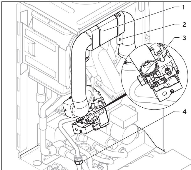
5. Выверните удерживающий винт (2) и снимите воздухозаборную трубу (1) со всасывающего штуцера.
