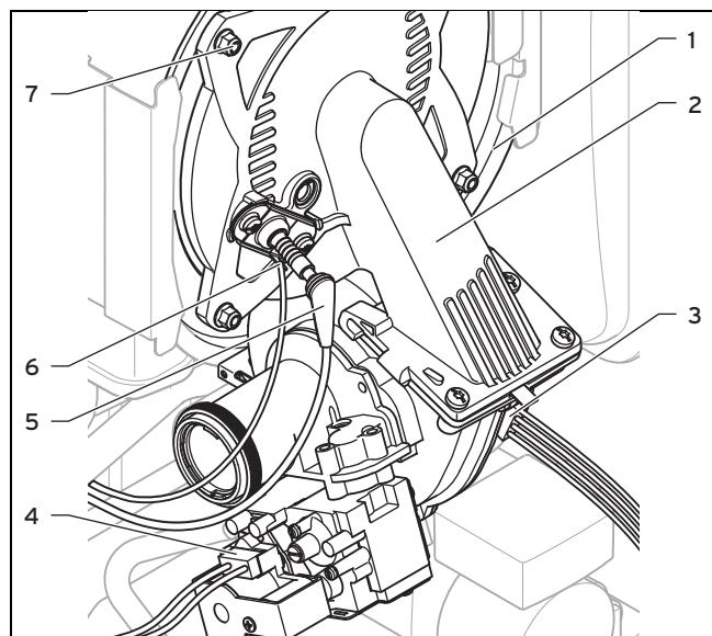
1. Наденьте термо-компактный модуль (2) на теплообменник (1).
