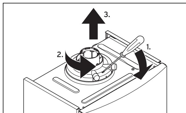
1. Вставьте отвертку в щель между измерительными штуцерами.
