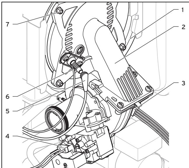
7. Отсоедините штекер провода электрода розжига (5) и заземляющего провода (6) от электрода розжига.
