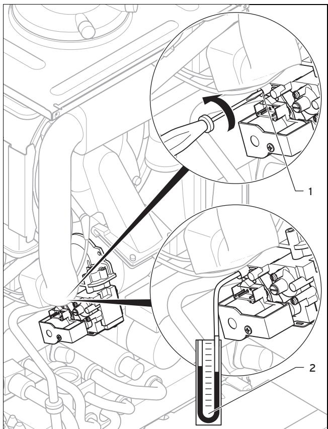
2. С помощью отвертки открутите винт измерительного штуцера (1) (нижний винт) на газовой арматуре.
