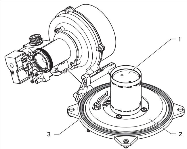
1. Проверьте поверхность горелки (1) на наличие повреждений. При обнаружении повреждений замените горелку.
