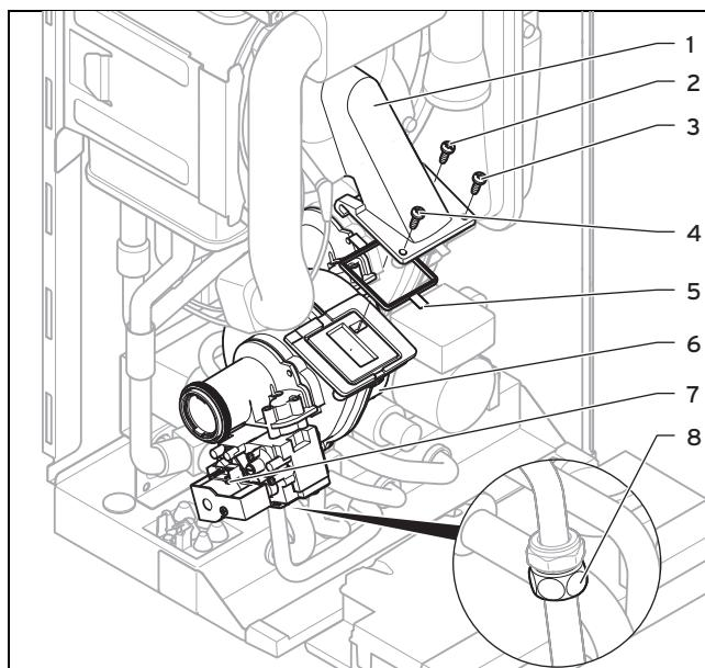
1. Снимите воздухозаборную трубу.
