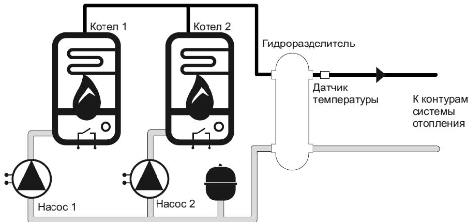
Рисунок 1 – Функциональная схема системы отопления
