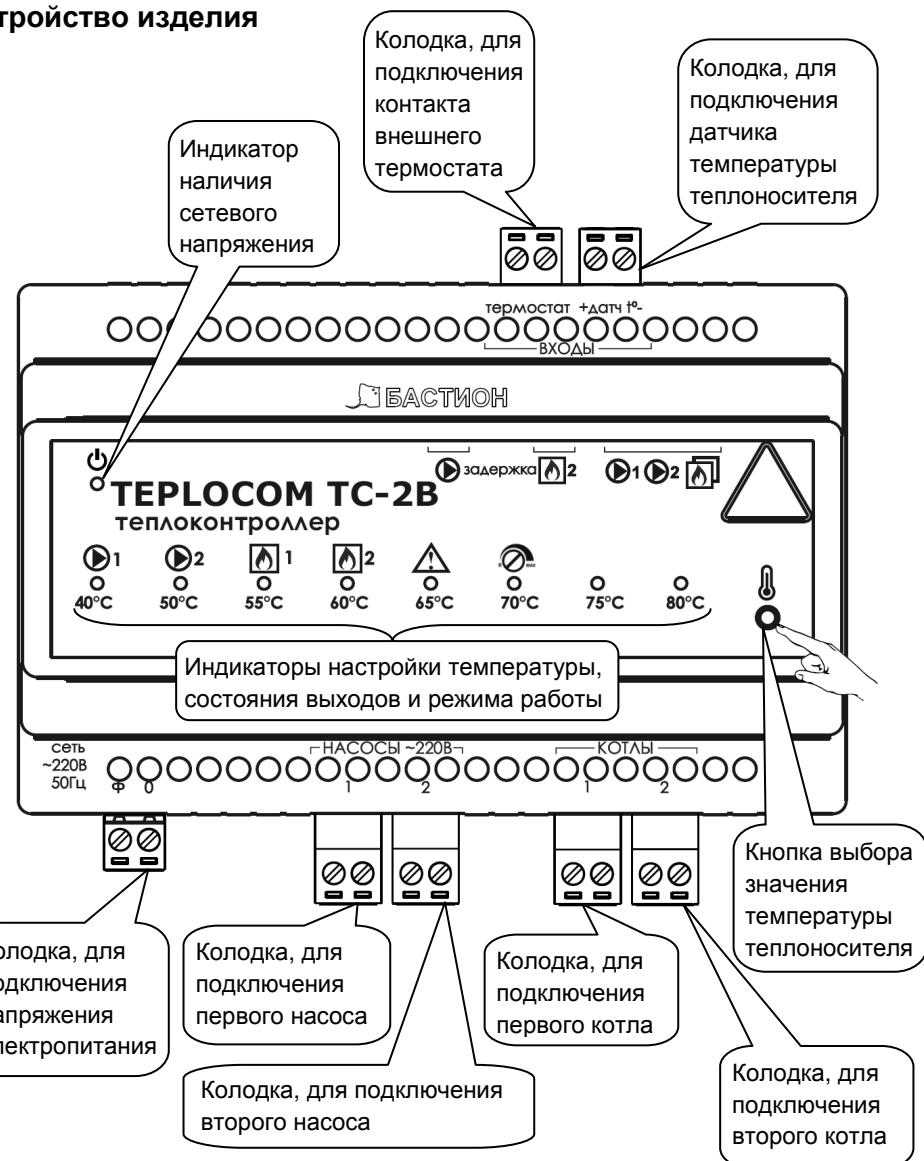
Рисунок 2 — Общий вид передней панели изделия
