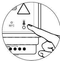
Однократно нажать на кнопку . Изделие перейдет в режим выбора значения температуры теплоносителя, а индикация — в режим отображения установленного значения температуры ( заводская установка — 50 °C )
