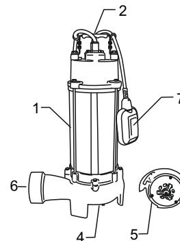
Насос (1) представляет собой моноблочный агрегат, корпус которого разделен на гидравлическую часть и электродвигатель. Однофазный асинхронный электродвигатель с пусковым конденсатором размещен в закрытом от попадания жидкости кожухе из нержавеющей стали.
