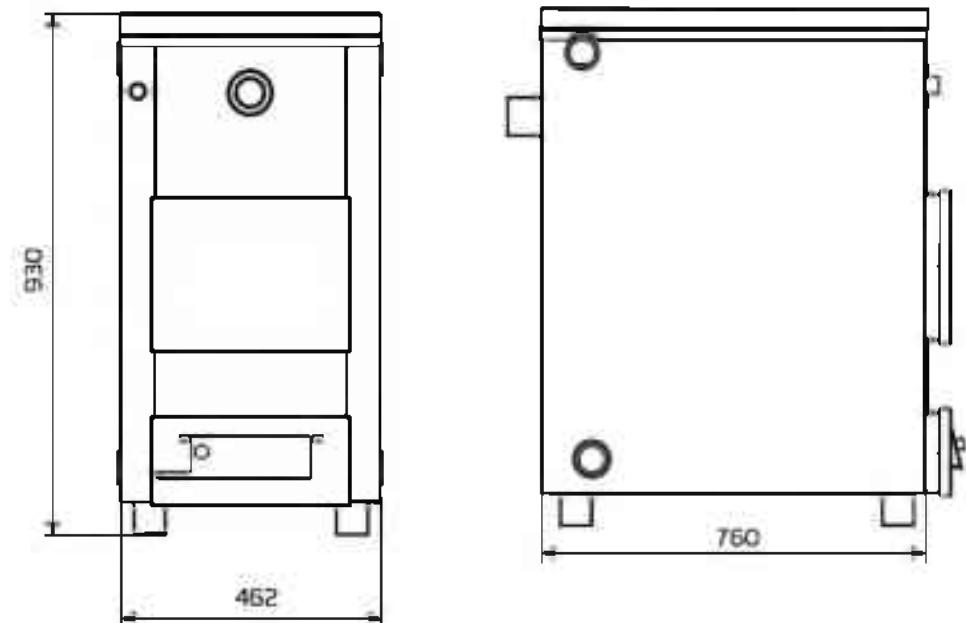
Рис. 4 Габаритные размеры котла «Сибирь-Гефест» 30 кВт
