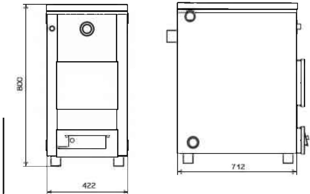
Рис. 3 Габаритные размеры котла «Сибирь-Гефест» 20 кВт
