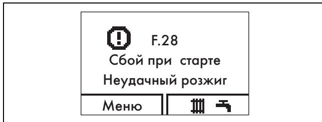
Если горелка не разжигается после пяти попыток разжига, изделие не запускается и переходит в режим неис-
