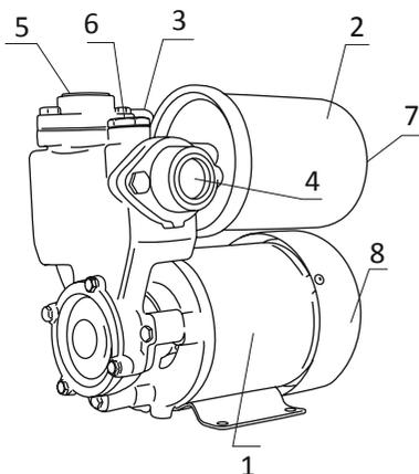
Станция состоит из следующих основных узлов: насоса с электродвигателем – (1), гидроаккумулятора – (2) и реле давления – (3). Насос имеет входное (4), выходное (5) и заливное (6) отверстия. На корпусе гидроаккумулятора расположен пневмоклапан (7) для регулировки давления воздуха. Во входном отверстии насоса (4) расположен встроенный обратный клапан, который используется в случае, когда станция монтируется в магистраль централизованной системы водоснабжения.
