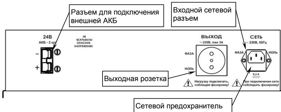
Рисунок 2 – общий вид задней панели источника
