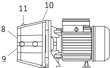
На корпусе насоса находятся два отверстия входной магистрали (8)-11/4" и (9)-1", выходное отверстие- (10)-1" и отверстие для первоначальной заливки воды- (11).
