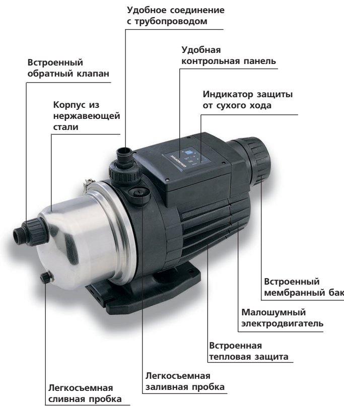
Поддача до 4 м³/ч Напор до 44 м Потребляемая мощность до 0,67 кВт Температура перекачиваемой среды до 35°C Высота самовсасывания до 8 м
