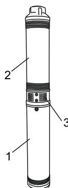
Насос состоит из электродвигателя (1) и гидравлической части (2).
