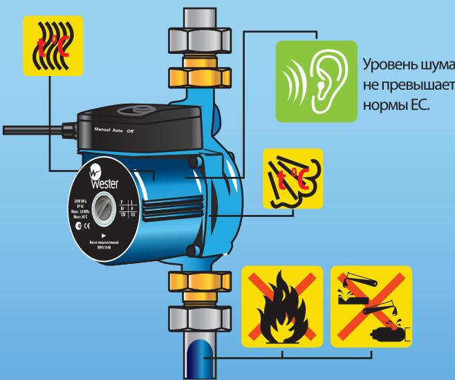
**Внимание:** Подшипники насоса смазываются водой, поэтому его не допускается включать без воды более чем на 10 секунд.
