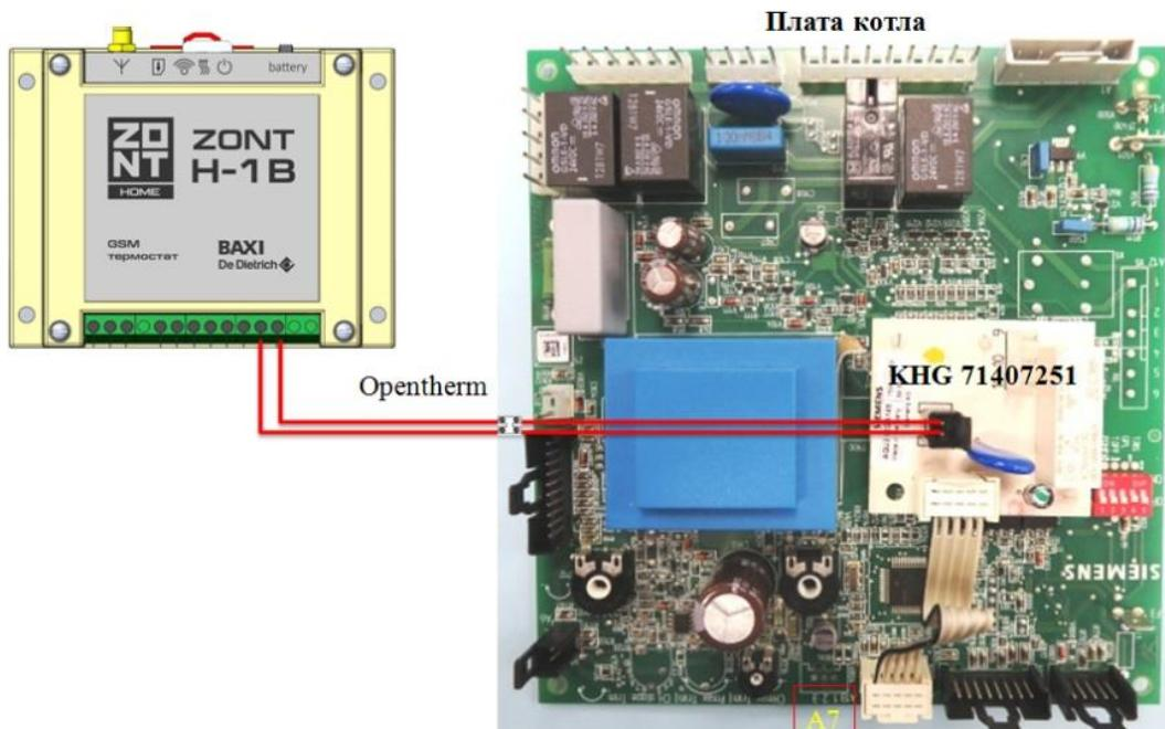
На плате напольного котла BAXI SLIM нет разъема цифровой шины OpenTherm. Для подключения вам потребуется заказать дополнительно плату - интерфейс арт. KHG 71407251 (заказать как отдельный аксессуар у производителя котла). Данная плата-интерфейс подключается к разъему A7 электронной платы котла, а уже к ней подключается термостат ZONT H-1B. Перемычку комнатного термостата на колодке электропитания рекомендуется снять.
