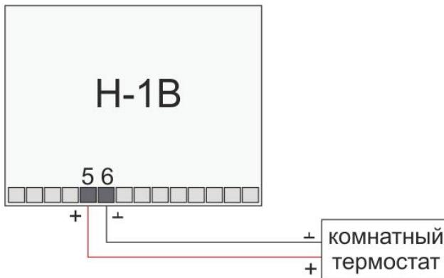
Для ручного управления работой термостата ZONT можно использовать простой двухпозиционный терморегулятор. Он подключается к аналоговому входу термостата по следующей схеме: К контакту 5 термостата подключается сигнальный выход терморегулятора (+), а второй выход терморегулятора (-) подключается к контакту 6 термостата.
