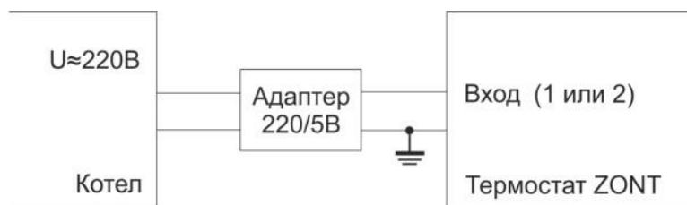
На выходе котла при аварии сигнал представляет собой переменное напряжение 220В. В этом случае необходимо подключение выхода котла к термостату через адаптер 220/5В.
