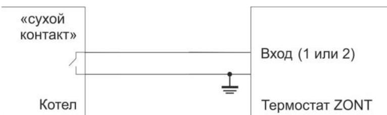
Выход котла имеет тип «сухой контакт». В этом случае допускается прямое подключение ко входу термостата.
