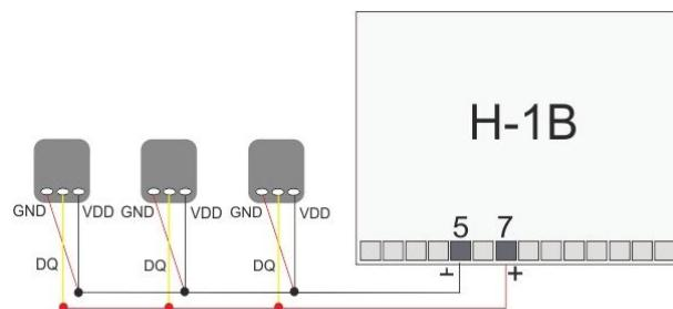
Датчик DS18B20 трехпроводной, но подключается по двухпроводной схеме:
