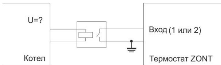
На выходе котла при аварии сигнал представляет собой постоянное напряжение. В этом случае необходимо подключение выхода котла к термостату через понижающее реле.
