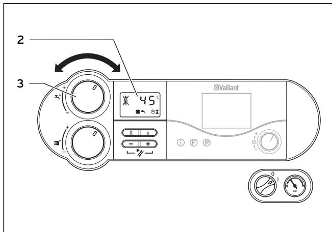
Рис. 4.5 Настройка температуры горячей воды
