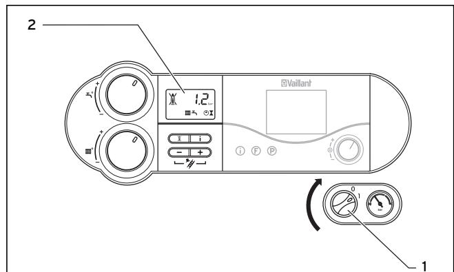
Рис. 4.4 Включение прибора
