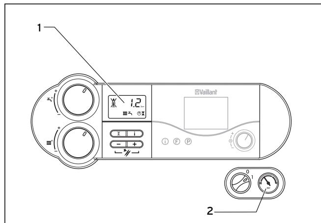
Рис. 4.14 Проверка давления наполнения отопительной установки
