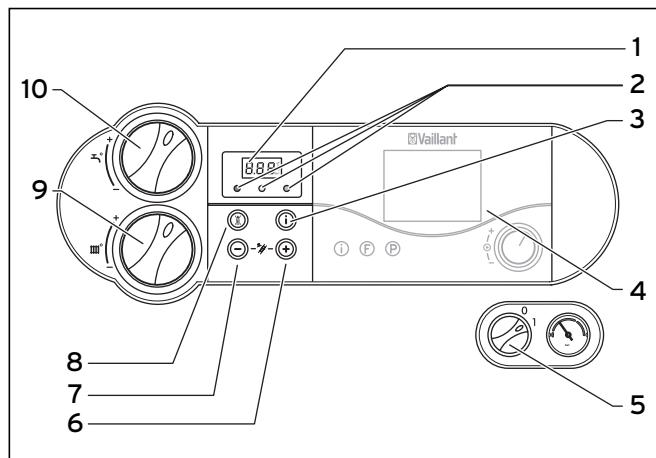
Рис. 4.3 Элементы управления (atmoTEC pro, turboTEC pro)
