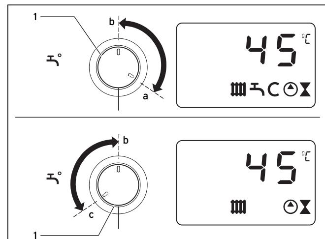
Рис. 4.6 Включение и выключение функции теплого пуска
