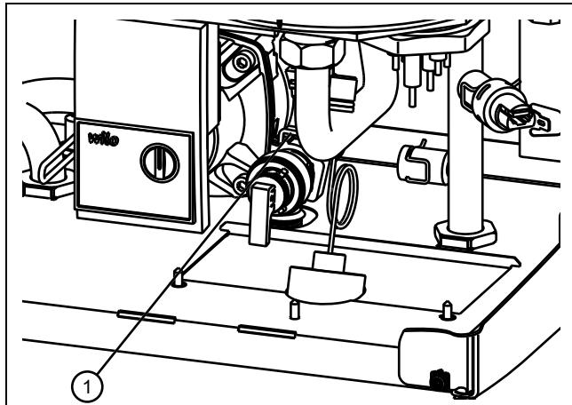
1. Снимите защитную скобу (1) и извлеките предохранительный клапан из изделия.
