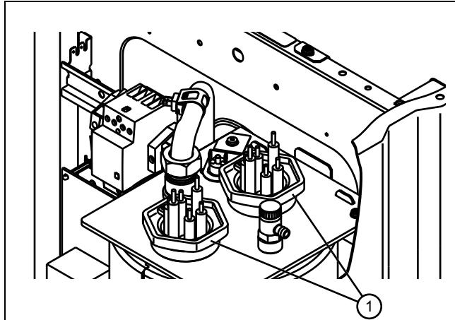
1. Отсоедините провода, идущие от ТЭНов (1) к электронной плате и колодке подключения к сети (N, синий).
