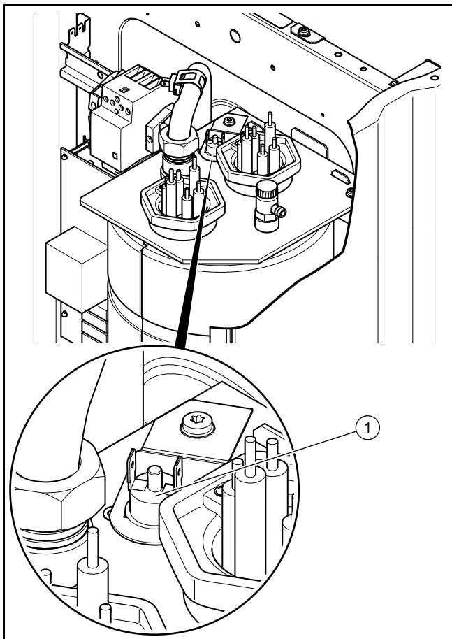
1. Отсоедините оба разъёма от датчика температуры (1).
