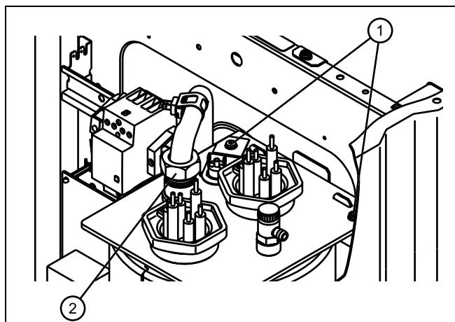
5. Открутите крепёжный болт (2) обратной линии системы отопления с верхней стороны теплообменника.
