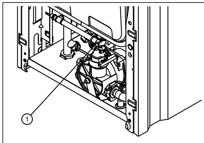
2. Раскрутите водопроводное резьбовое соединение (1) с нижней стороны расширительного бака.
