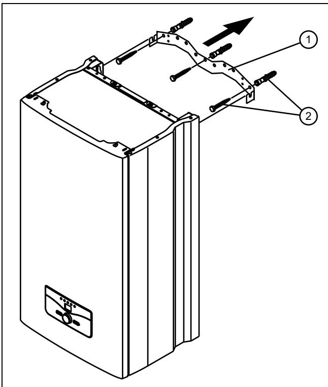
1. Приложите планку для крепления прибора (1) к стене и отметьте три отверстия.
