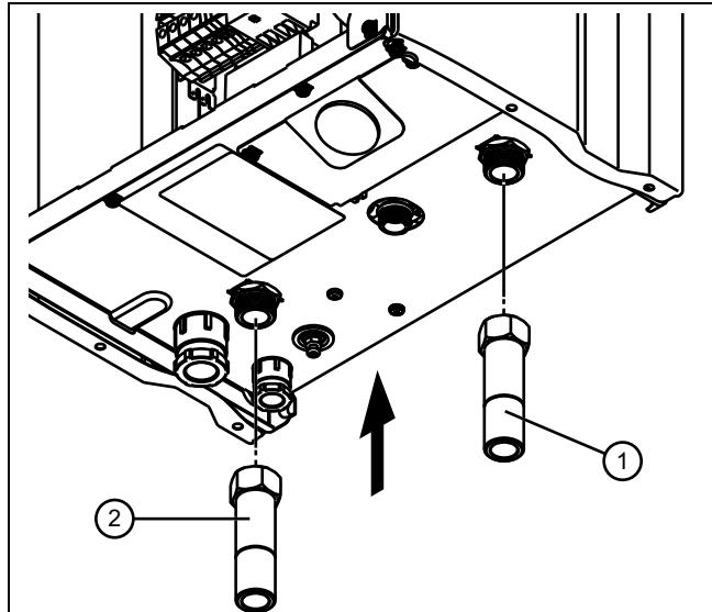
1. Присоедините трубопровод подающей линии системы отопления (1) к патрубку подающей линии системы отопления.
