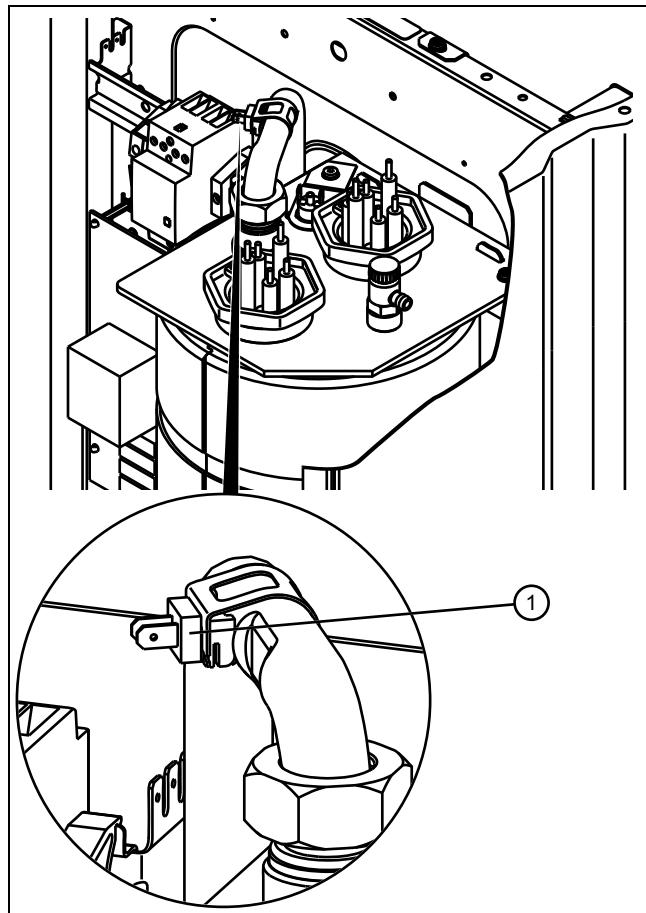
1. Отсоедините оба разъёма от предохранительного ограничителя температуры (1).
