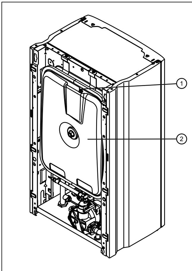
1 Штуцер для проведения измерений      2 Расширительный бак
