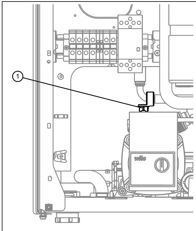
1. Открутите колпачок быстродействующего воздухоотводчика (1) на насосе на один-два оборота.
