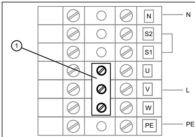
1. При отсутствии трехфазного разъема подключите изделие к сети однофазного тока.
