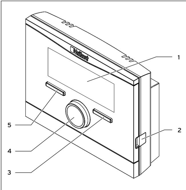
Рис. 3.1 Вид calorMATIC спереди
