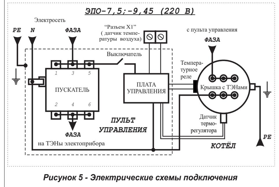
**Рисунок 5 - Электрические схемы подключения**
