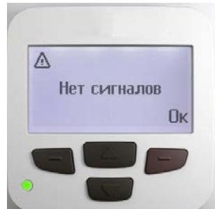
Если прибор работает нормально, то на экране высвечивается - **Нет сигналов**
