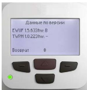
На экране отображается информация о номере версии экранного блока и платы реле
