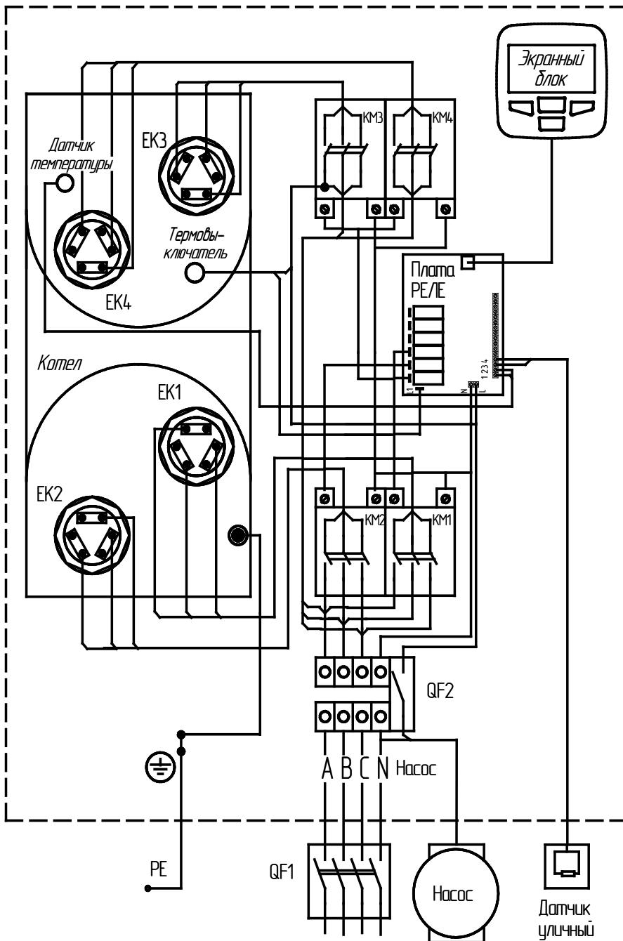
Схема подключения ЭВАН UNIVERSAL -60
