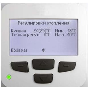
**Кривая** - текущая температура подачи теплоносителя (температура уставки теплоносителя при текущей уличной температуре определяемая согласно управляющей нагревом функции - кривой тепла)
