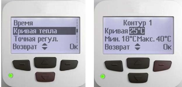
7.2.6.2 Нажимая **ВК** и **НК** выбираем нужную отопительную кривую (от 22°C до 60°C).
