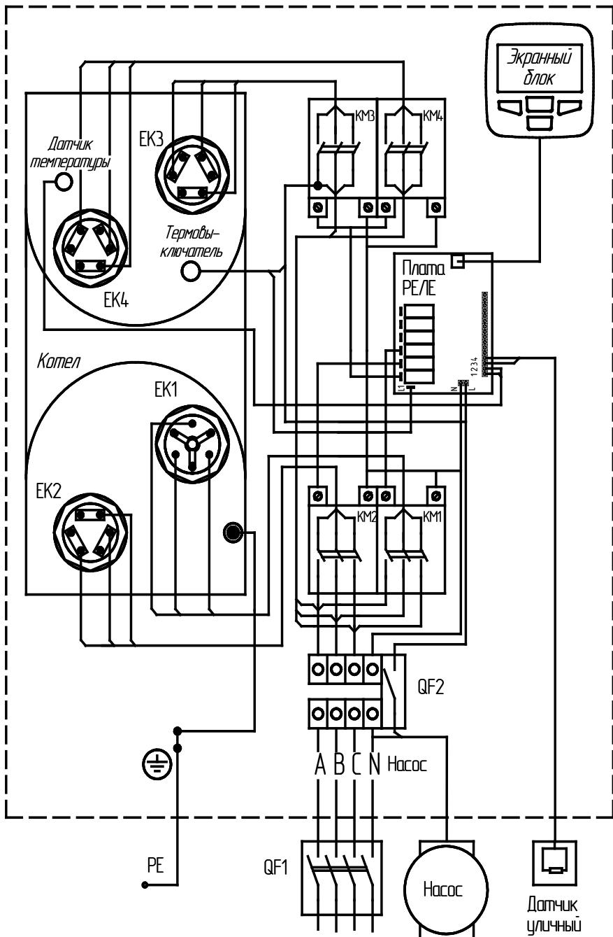
Схема подключения ЭВАН UNIVERSAL -48, 54
