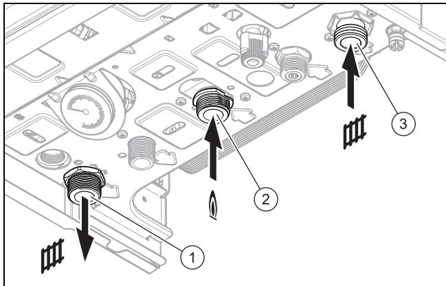
1. Выполните установку газопровода к подсоединению газа (2) без механических напряжений.
