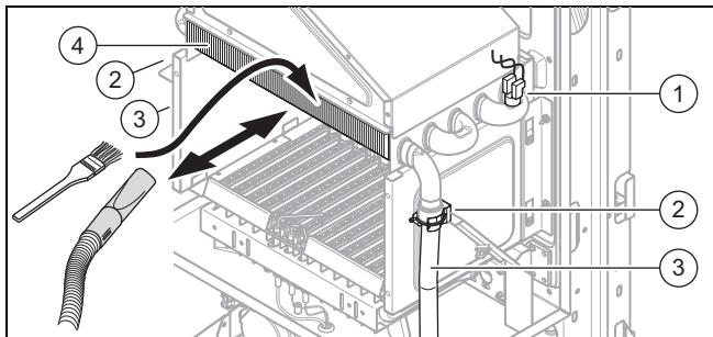
2. Снимите скобы (2) на трубе подающей и обратной линии (3).
