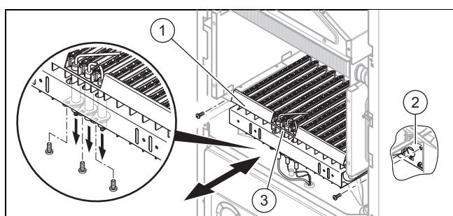
1. Открутите винты на газораспределительной трубе (2).
