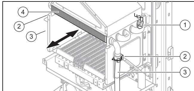
1. Снимите скобы (2) на трубе подающей и обратной линии (3).
