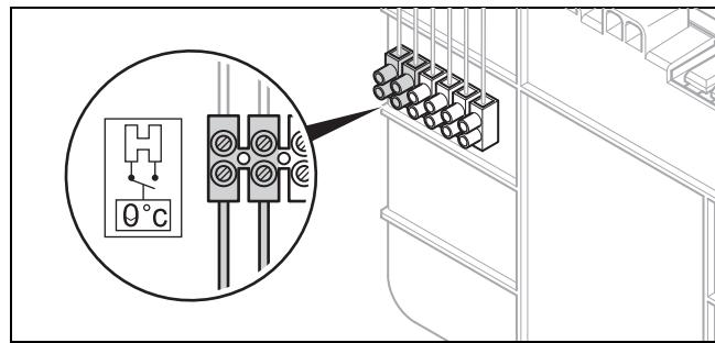
3. Подсоедините кабель комнатного термостата к соответствующей клемме.
