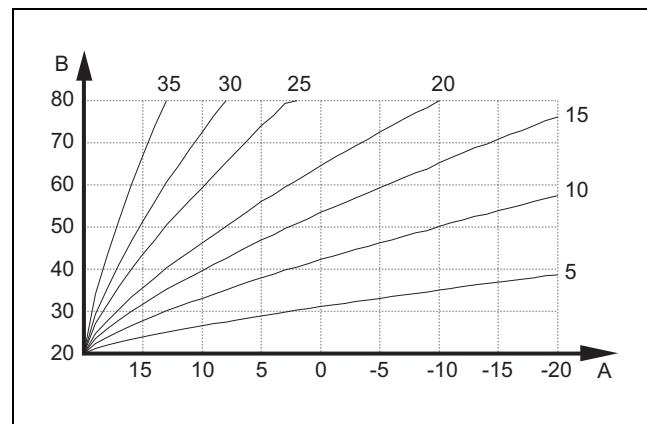
2. Для поддержания постоянной температуры помещения отрегулируйте соответствующее значение на основании температуры наружного воздуха (**A**) и температуры в подающей линии системы отопления (**B**).
