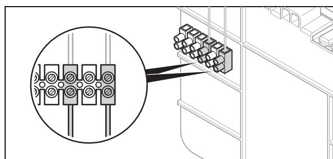
3. Подсоедините кабель датчика температуры наружного воздуха к соответствующей клемме.
