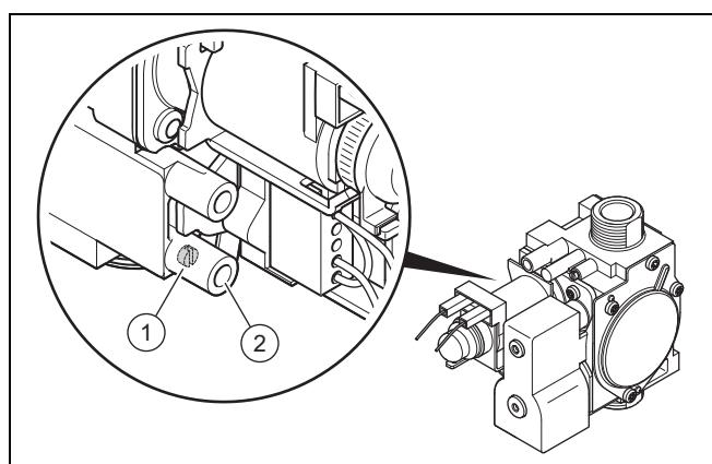
5. С помощью отвертки открутите уплотнительный винт (1) на измерительном штуцере (2) на газовой арматуре.
