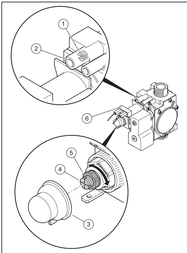
4. Открутите уплотнительный винт (1) на ниппеле для проведения измерений (2).
