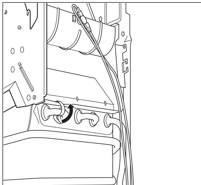
Рис. 7.5 Демонтаж теплообменника
