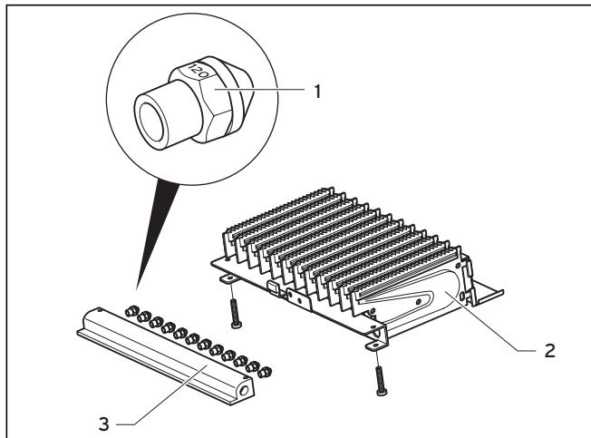
Рис. 6.6 Маркировка сопла
