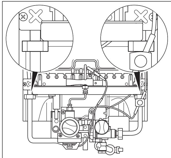
Рис. 7.4 Патрубки подачи и отвода воды на теплообменнике
