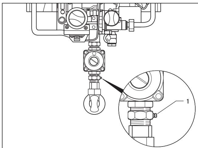
Рис. 6.1 Патрубок для измерения давления газа на входе
