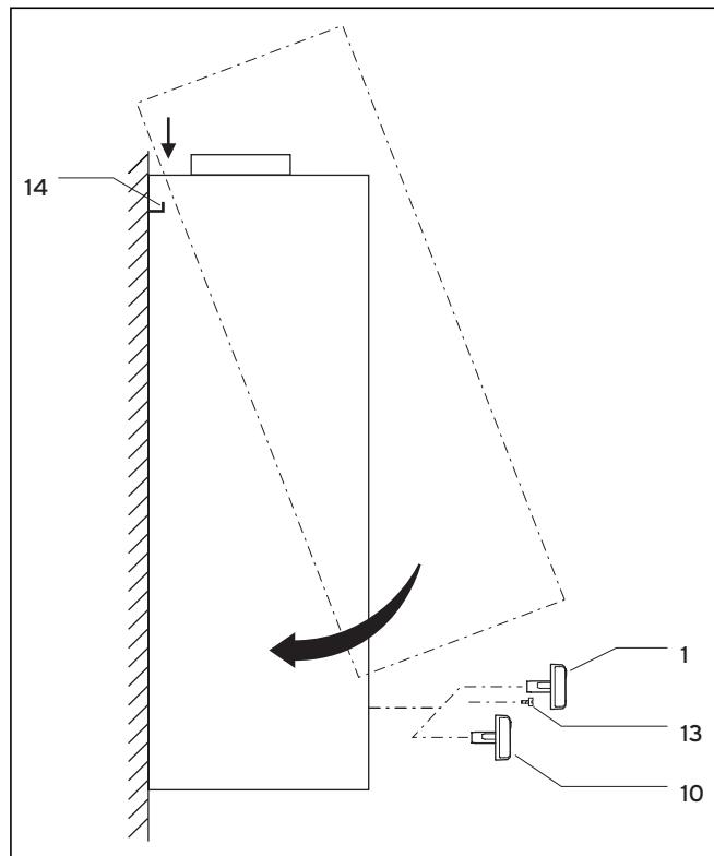
Рис. 4.5 Установка кожуха
