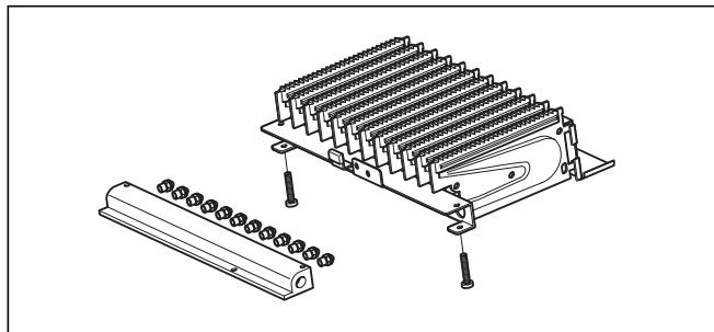
Рис. 7.3 Конструкция горелки
