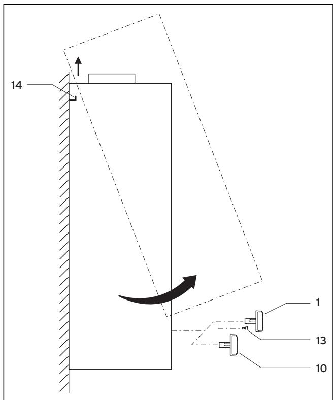
Рис. 4.4 Снятие кожуха
