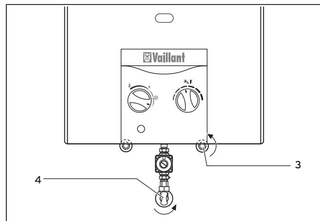
Рис. 4.2 Запорные устройства
