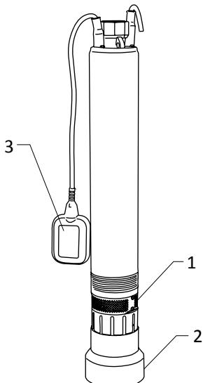
Встроенный обратный клапан предотвращает слив жидкости из шланга после остановки насоса и сокращает время всасывания при его повторном запуске.
