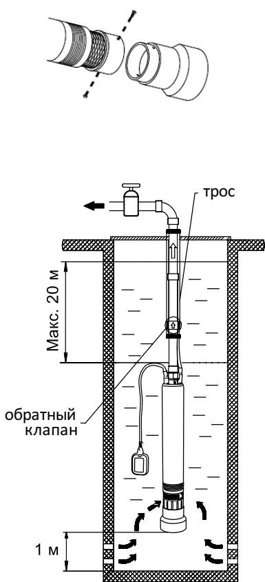
Это защитит насос от всасывания грязи. При установке насоса в колодцах, расстояние от дна колодца до насоса должно быть не менее 1 м. При необходимости установите на выходное отверстие насоса переходной ниппель. Закрепите трос в проушинах насоса.
