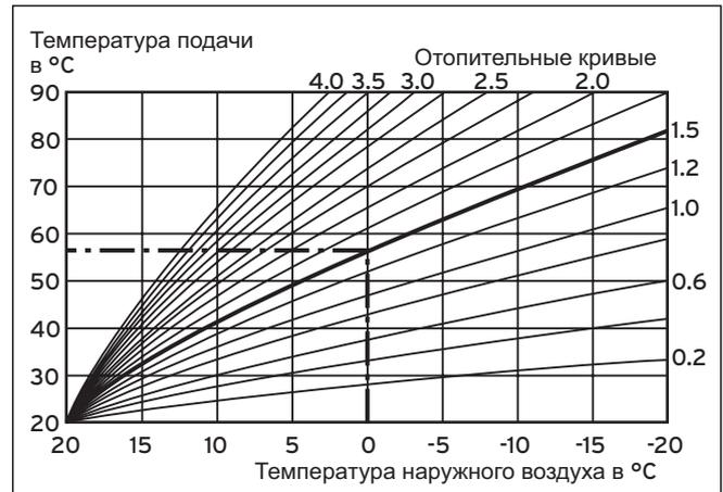
Рис. 3.3 Диаграмма с отопительными кривыми
