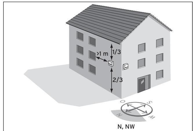
Рис. 4.8 Место монтажа датчика температуры наружного воздуха VRC 693
