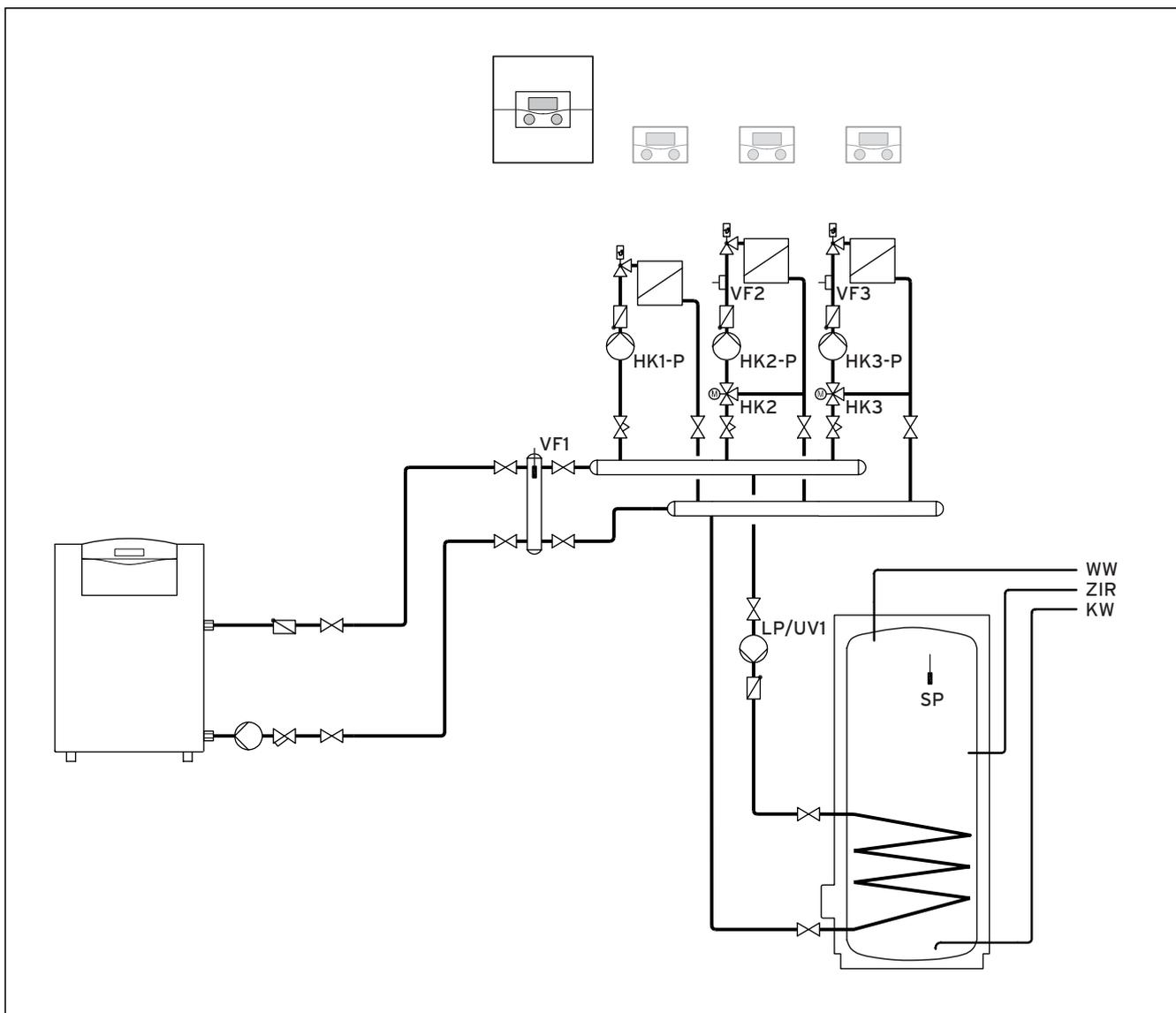
Рис. 5.9 calorMATIC 630 в комбинации с котлом ecoCRAFT
