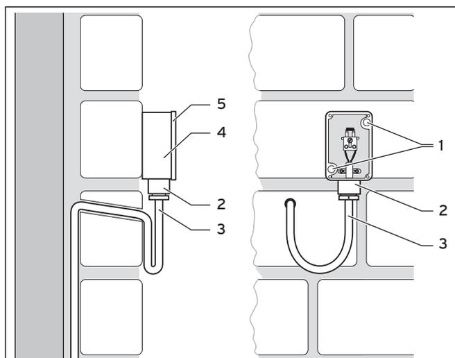
Рис. 4.9 Монтаж датчика температуры наружного воздуха VRC 693
