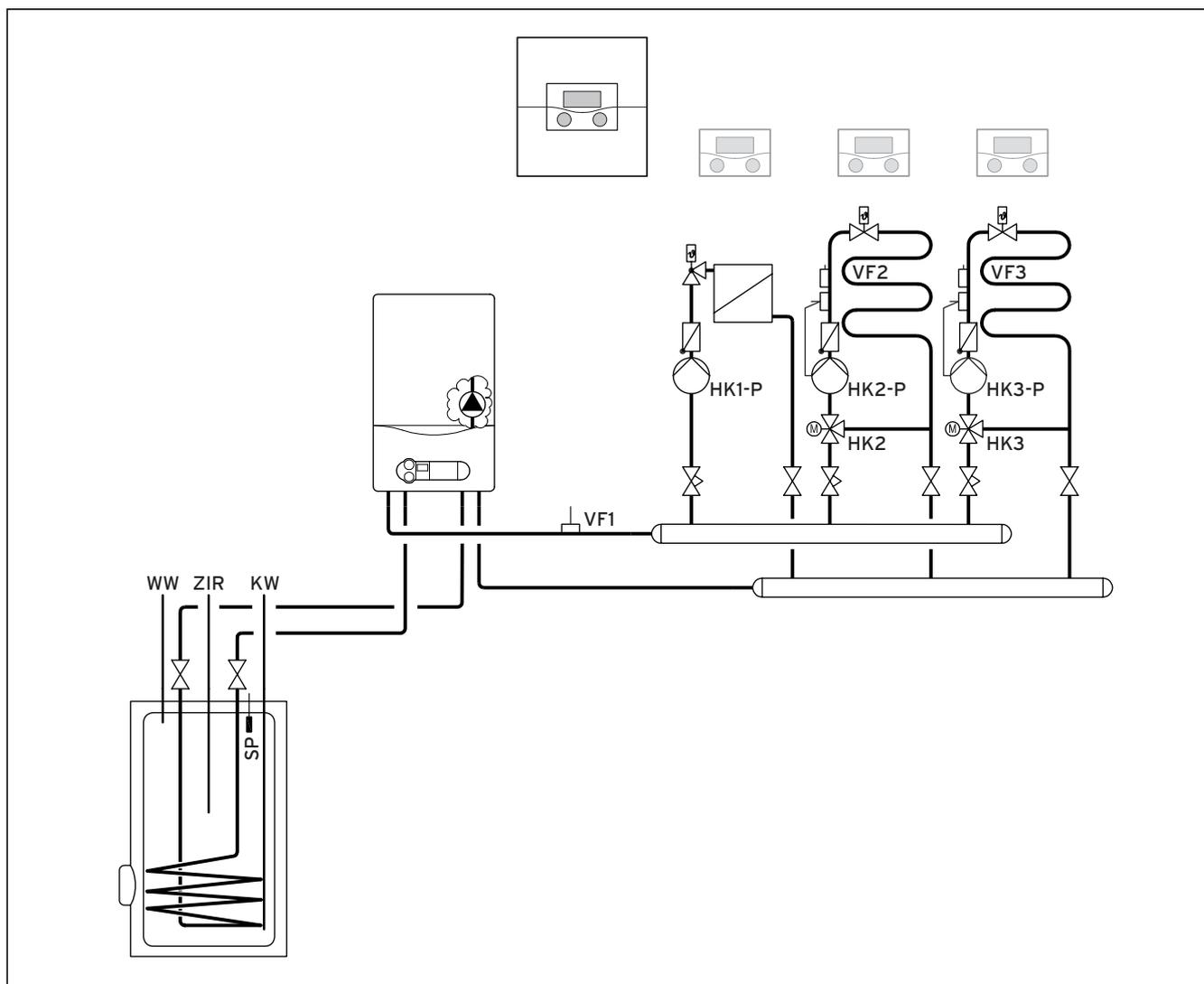
Рис. 5.5 Настенный отопительный аппарат с VRC 630
