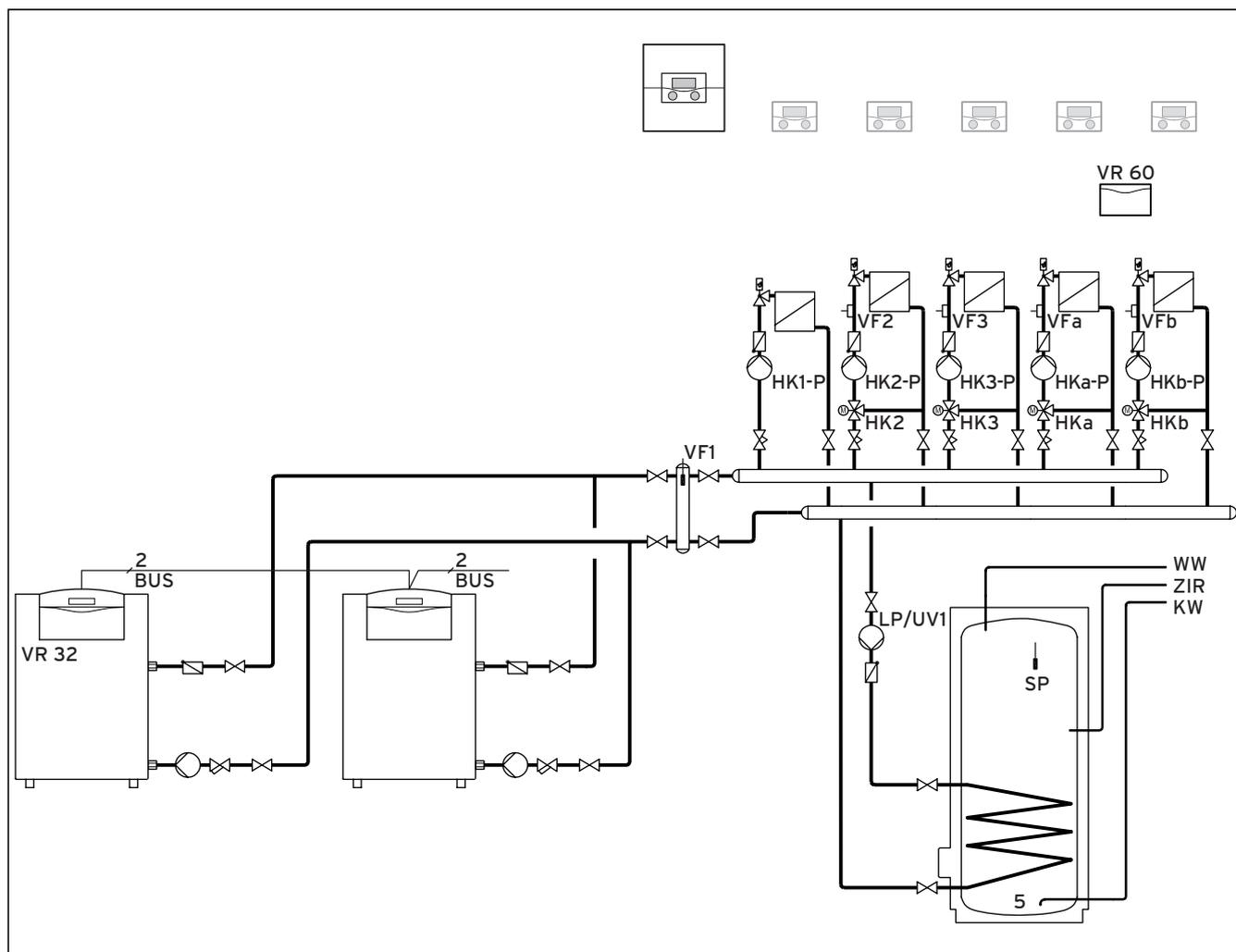
Рис. 5.10 calorMATIC 630 в комбинации с двумя котлами ecoCRAFT
