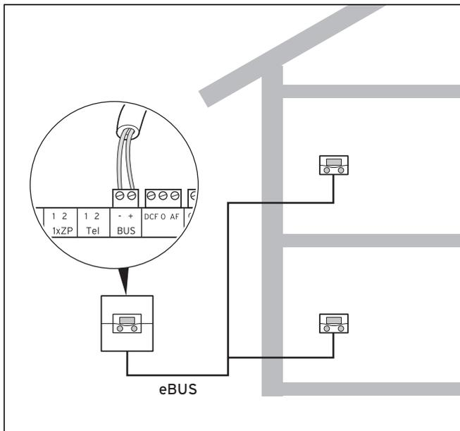
Рис. 5.12 Подключение приборов дистанционного управления
