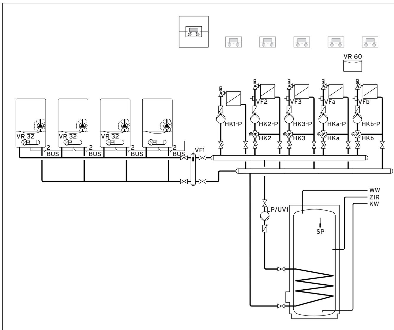
Рис. 5.6 Настенные отопительные аппараты с VRC 630 VIH за разделителем
