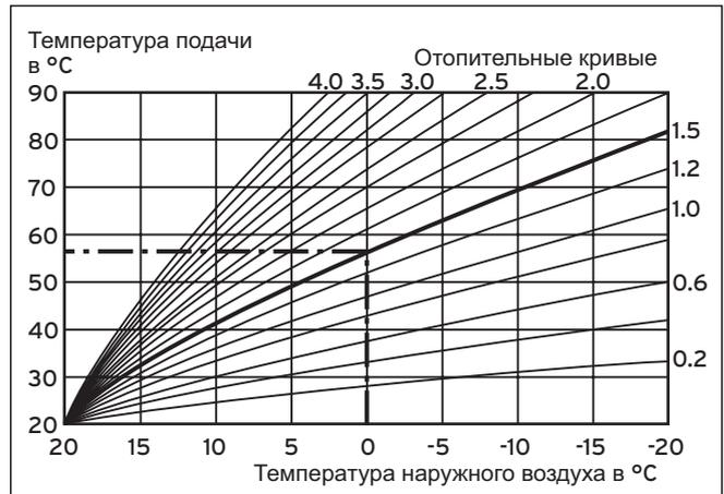
Рис. 3.3 Диаграмма с отопительными кривыми
