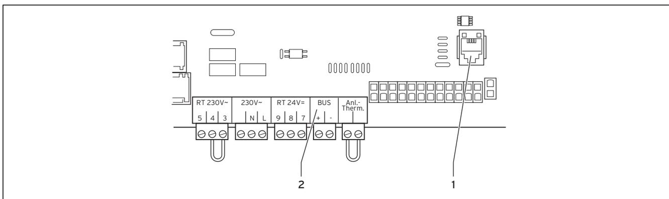
**Рис. 5.7 Электроблок для подключения коммутационного модуля VR 32**
