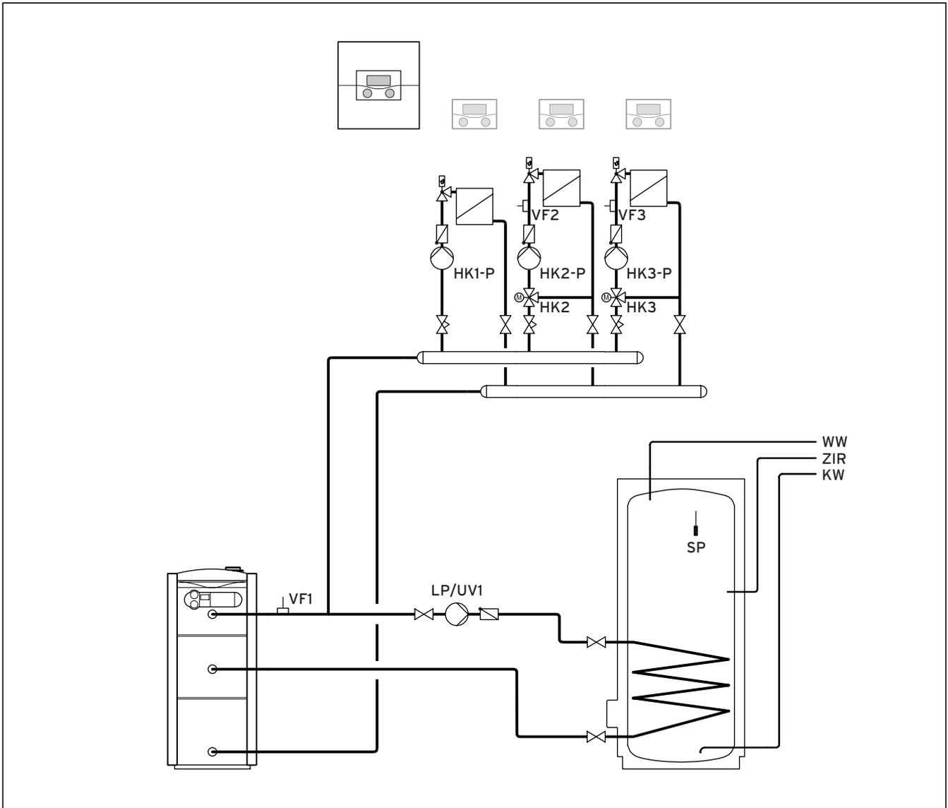
Рис. 5.8 Регулятор calorMATIC 630 и один напольный аппарат
