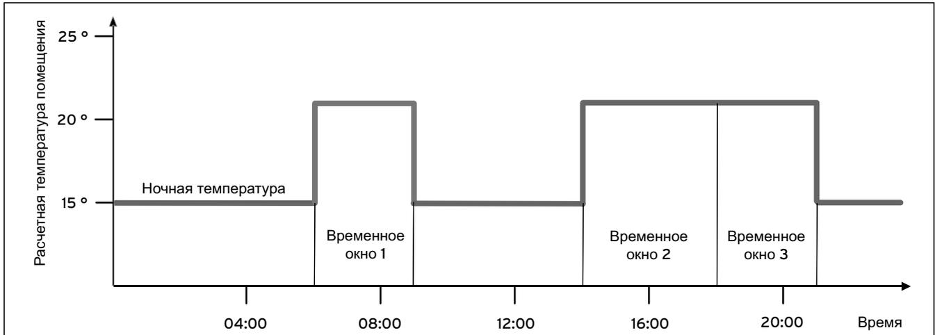
Рис. 3.2 Автоматический режим отопления: Пример настройки расчетного значения температуры помещения на различное время дня
