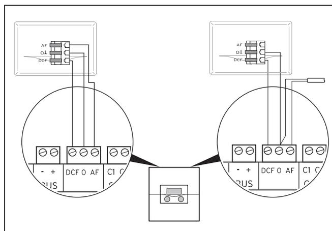
**Рис. 5.11 Подключение DCF-приемника**
