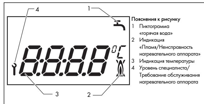
Рис. 1.2 Общий вид дисплея
