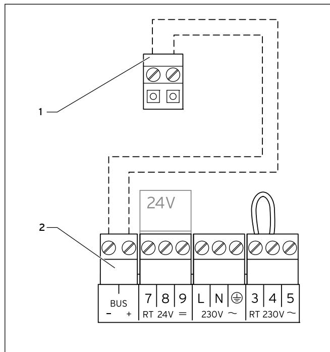
Рис. 5.1 Подсоединение регулятора
