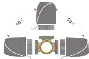
Но рекомендуется ориентировать его таким образом, чтобы конденсат или подтекающая вода не смогли попасть внутрь корпуса привода.
