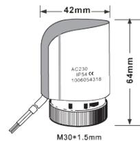
Электротермические сервоприводы предназначены для двухпозиционного регулирования в системах отопления и холодоснабжения. Используются для зонального регулирования в системах радиаторного и напольного отопления. Устанавливаются на запорно-регулирующие клапаны коллекторных групп, термостатические клапаны радиаторов, клапаны для фанкойлов и зональные клапаны. Приводятся в действие от комнатного термо-стата или специализированного контроллера. Работают бесшумно и потребляют мало энергии.
