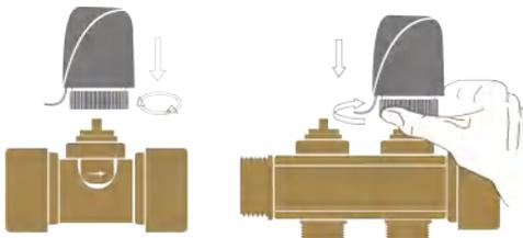
Надев привод, на клапан следует вручную закрутить накидную гайку до упора. Использование какого-либо инструмента для затягивания накидной гайки не допускается.
